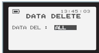
② 【ENT】を押すとNOが選択されます。【<】【>】でYESを選択し【ENT】を押します。DATA DEL OKと表示され全データが消去されます。
