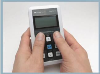
④ 計測が開始されます。【△】【▽】でSCAN速度を選択出来ます。計測を止めるには【RUN/STOP】を押します。
